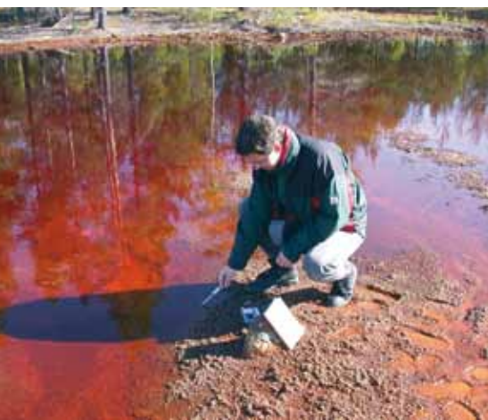
Messung des pH-Wertes in eisenreichen, sauren Minenwässern unterhalb einer Abraumhalde in Kristineberg, Schweden
