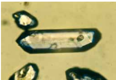
Zirkon aus einem Alpengranit. Das Verhältnis von Uran- zu Bleiatomen verrät das Alter des Minerals.
