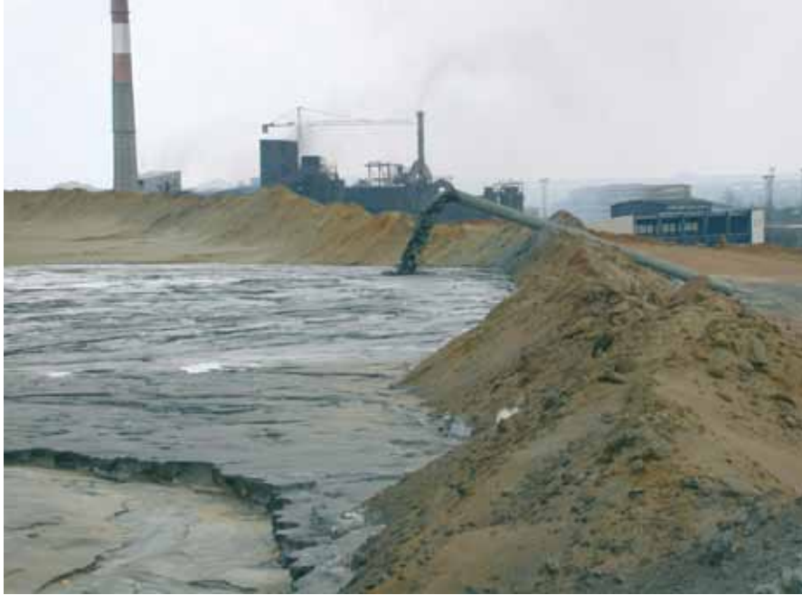
Aufbringen von Aufbereitungsrückständen der Kupfer-, Nickel- und Kobaltmine in Selebi-Phikwe, Botswana
