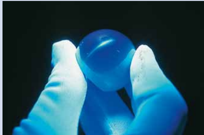
Künstliche Hüftgelenkkugel aus Aluminiumoxid-Keramik
