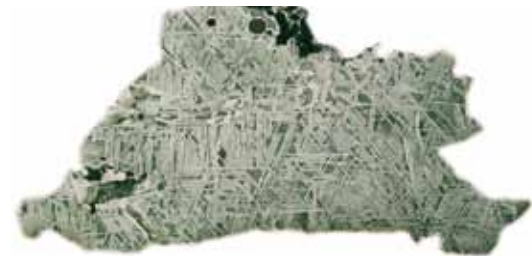
Angeätzter Eisenmeteorit mit Widmansstättenschen Figuren
