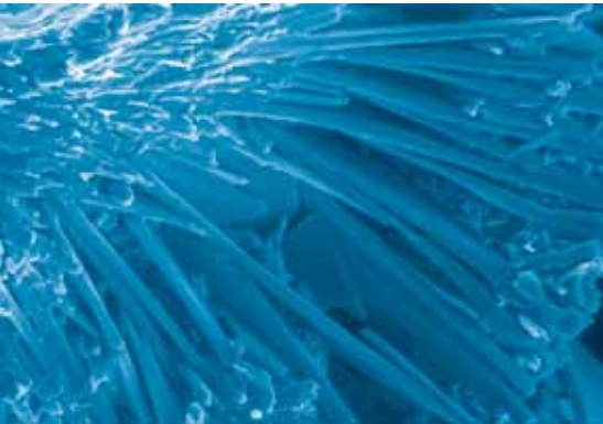
Natriumsulfat in Porenbeton, ESEM-Elektronenmikroskop
