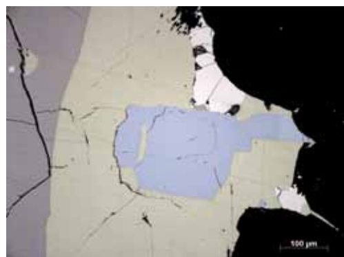
Auflichtmikroskopisches Bild eines Platin-Erz-Anschliffes mit sulfidischen Platin-Mineralen
