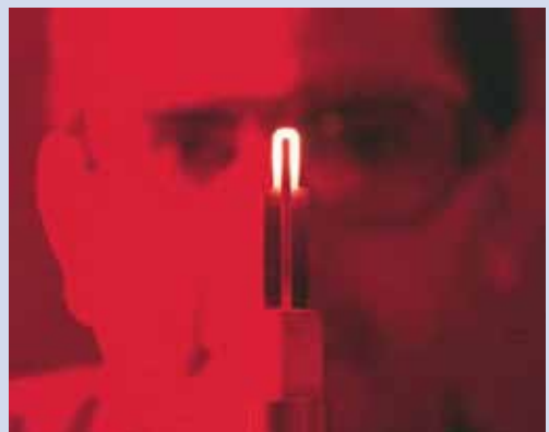
Leitende SiC-Keramik aus Nanopartikeln
