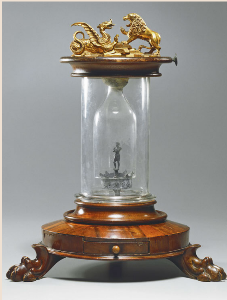
Döbereiner Feuerzeug, nach 1823. Die Austrittsdüse für das entwickelte Wasserstoffgas befindet sich im Maul des Drachens, der es gewissermaßen gegen einen Löwen speit, der seinerseits den als Katalysator benötigten Platinschwamm in seinem Maul hat. Die Zink-Stückchen wurden in einer Bleischale aufgelöst, in der die Figur des englischen Admirals Nelson steht. Foto: Deutsches Museum
