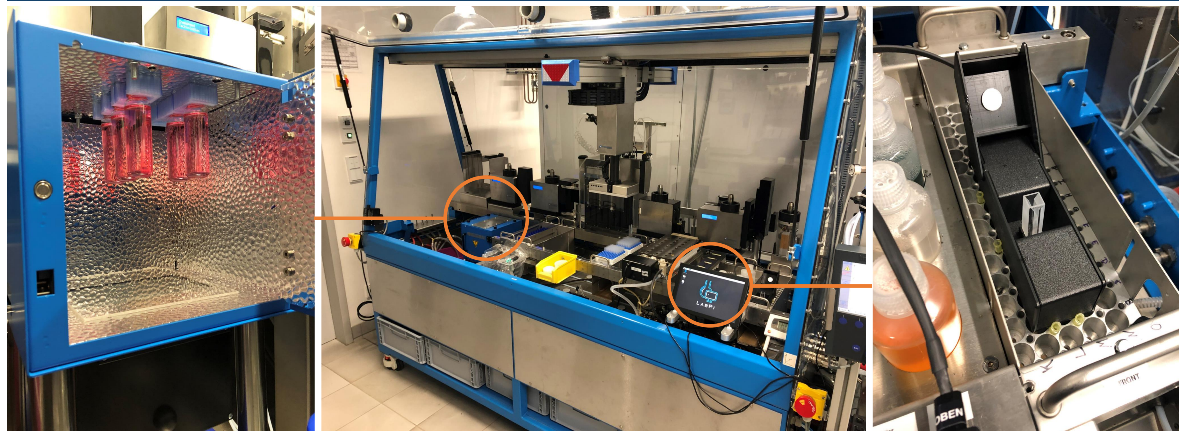
Abb. 4: UV-Kammer (links), Syntheseroboter Chemspeed SWING XL zur Probenentnahme (mitte), LabPi-Photometer zur Extinktionsbestimmung im UVa-Bereich [6].
